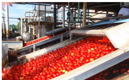
Friss paradicsomok a szállítószalagon. A feldolgozás első lépései.
