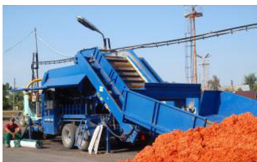
A Göweil LT Master bálázó és a friss alapanyag keverés előtt, valamint a kukricadarával történő keverés.
