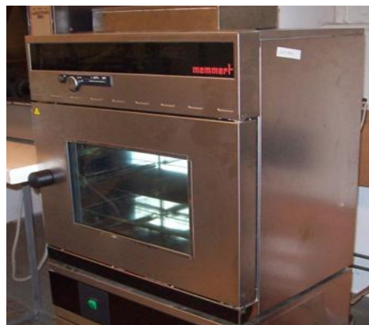
5. kép: MEMMERT-VO típusú vákuumszárító (Saját forrás)
