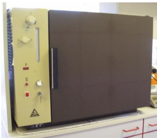
4. kép: LP-322 típusú szárító szekrény (Saját forrás)
