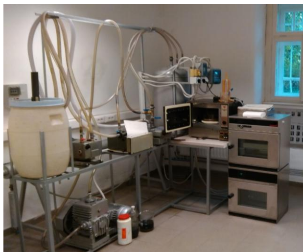
6. kép: LABOTRON mikrohullámú szárítószekrény (Saját forrás)
