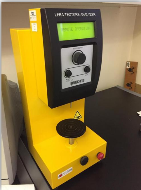
7. kép: Brookfield LFRA Texture Analyzer (Saját felvétel)
