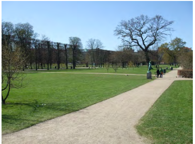
530-531. a stabilizált burkolattal kontrasztban van a szegély, ill. a kapcsolódó gyepfelület, amelyek természetes vezetőelemként szolgálnak
