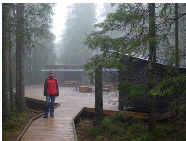
755-756. kifejezetten akadálymentesnek jelölt pallóösvény nemzeti parkban; ahol szükséges, kerékvető és korlát adott
