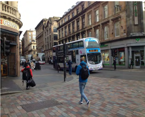
358-360. a rávezetés is figyelmeztetőelemekkel történik; az átkelést az útburkolaton nem jelölik, így hiányzik a vizuális kontraszt
