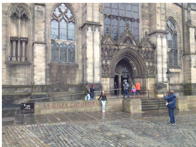
97-98. utólagos, a környezetbe simuló akadálymentesítés alternatív útvonalakkal (lépcső, korláttal kísért rámpa, korlát nélküli rámpa)
