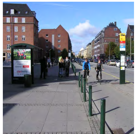
450-452. a járdán kialakított, színében nem kontrasztos TWSI figyelmeztetőjelzés mutatja az első ajtó helyét; a kerékpárosok figyelnek
