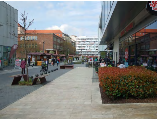
142-143. azonos szinten levő, eltérő forgalmi zónáknál fontos a kontraszt (a látássérültek és a vakvezető kutyák nehezen vagy nem érzékelik)
