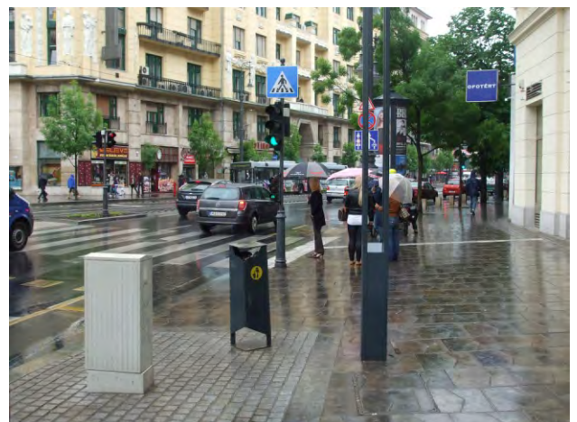
282-283. rávezetés a járda teljes szélességében; a fa elég messze van a vezetősávtól, de a pollerek a figyelmeztetősávban hegyesek
