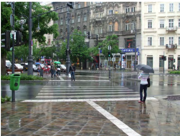
292-293. ha a vezetősáv átkelő tengelyével való párhuzamos kialakítása nem lehetséges, akkor is tartson az átkelőhelyen belül
