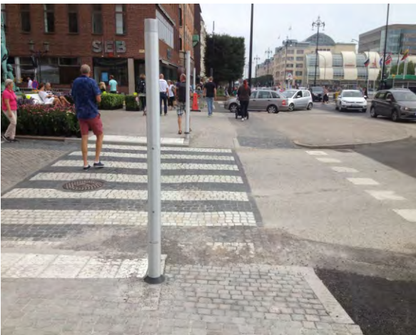
331-333. 2018-ra a figyelmeztetősávok lépéshossznyira szélesedtek; a vezetősáv olyan szélességű, hogy magán a jelzésen lehessen haladni
