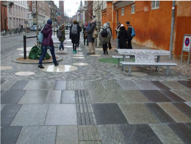
212-213. egyedi mesterséges taktilis jelzések egyedi terméskő burkolatban; a kerékpárút és járda közti kis szegély éljelöléssel ellátva
