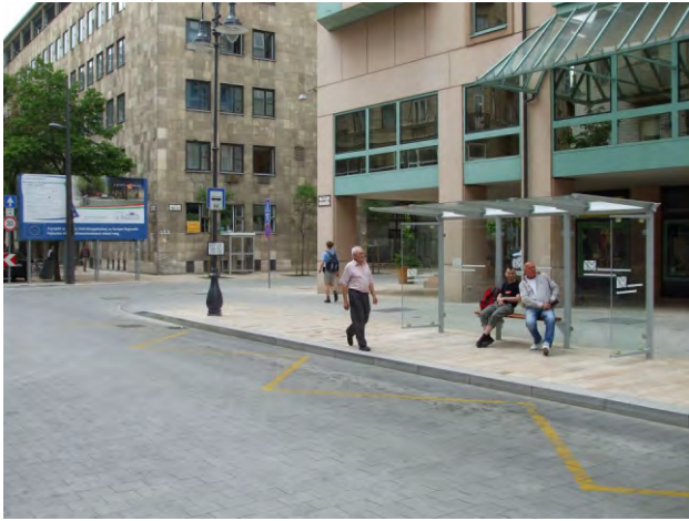
434-435. az első ajtó helye nem jelzett a burkolatban, megtalálását semmi nem könnyíti; kerekesszéssel a peron használható
