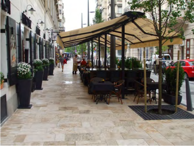
151-153. a homlokzat követését nehezítő tereptárgyak (különösen a látássérültek által nem érzékelhető konzolos elemek) veszélyt jelentenek
