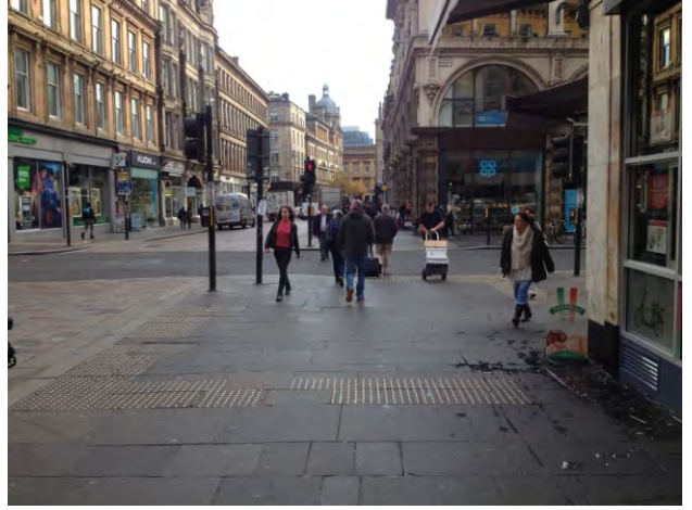
356-357. hazai tapasztalatok szerint a raszterben rakott figyelmeztetés mérsékeltlen alkalmas vezetésre, de emiatt figyelmeztetésre kevésbé
