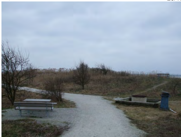
705-706. akadálymentesen, kerékpárral is használható stabilizált burkolat; a berendezési tárgyak hozzáférhetően, külön öblözetben
