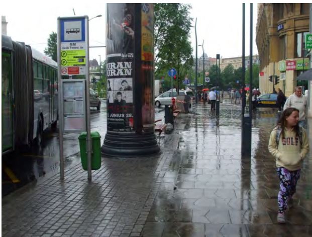
441-442. az első ajtó helye nem jelzett a burkolatban, megtalálását semmi nem könnyíti; kerekesszéssel a peron használható
