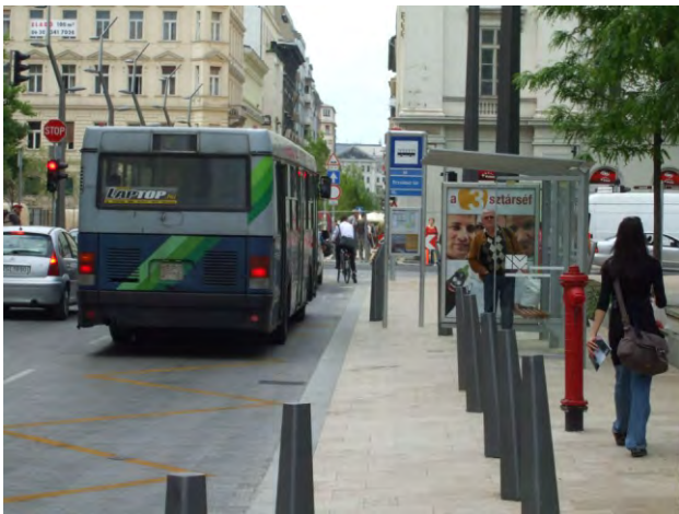
436-437. az első ajtó helye nem jelzett a burkolatban, megtalálását semmi nem könnyíti; kerekesszéssel a peron használható
