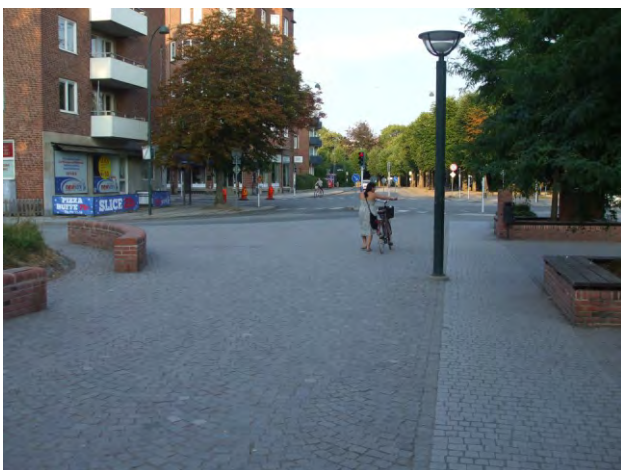
203-204. finom taktilis kontraszt orientál a teresedésben, ill. eltérő rakásmódú kiskockakő jelzi a forgalom holttereit
