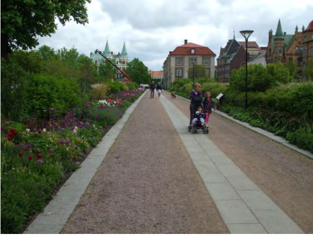
537-538. a stabilizált burkolattal kontrasztos szegély, ill. a kapcsolódó növényfelületek természetes vezetőelemként szolgálnak
