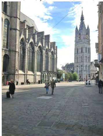
228-230. a Genben használt, csak taktilis kontrasztot nyújtó jelzésrendszer (a környező burkolat felületi érdessége szintén fokozott)
