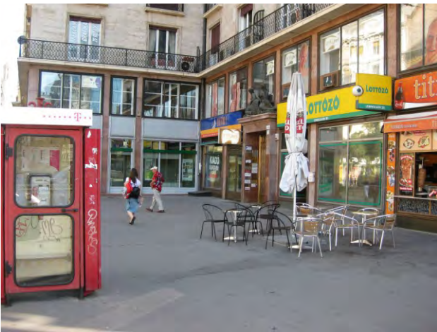
178-179. a megújításkor alkalmazott, kontrasztos-sávos burkolatminta önmagában alkalmas a funkciók jelzésére és az orientálásra
