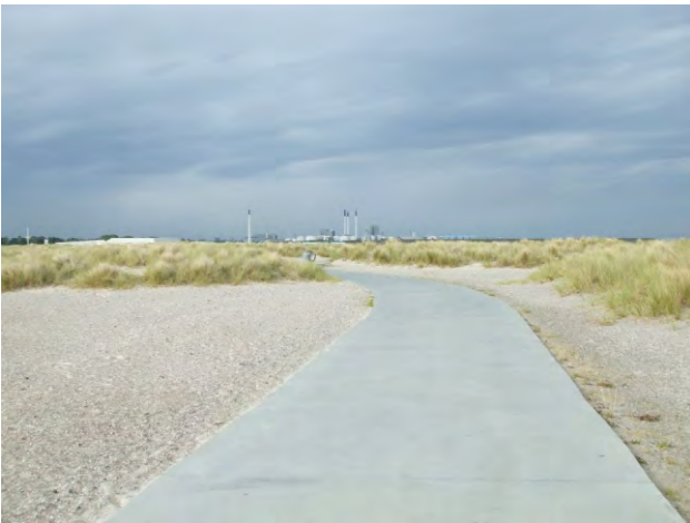
771-772. a süppedős homoktalajon kerekesszéssel csak úgy lehet átközlekedni, ha adott egy szilárd burkolatú gyalogosútvonal
