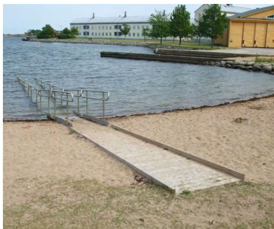
686-687. a kerekesszékkal való vízhez jutást segítő stég és rámpa
