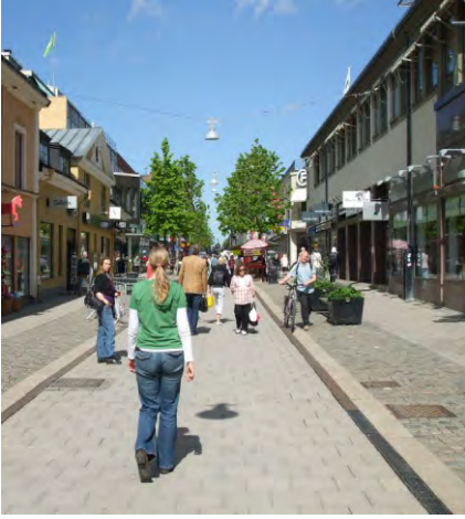
205-207. a vonalas vízvezető rácsokat sok látássérült ember használja természetes vezetősávként (rácsköz &lt; 2cm)
