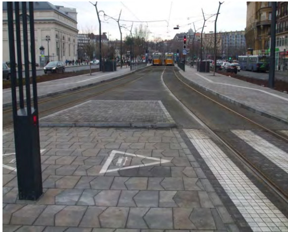
299-300. nem követték a terveket: a vezetősáv átkelőknél mindig figyelmeztetősávba fusson! magán az átkelőn hazánkban nincs vezetősáv
