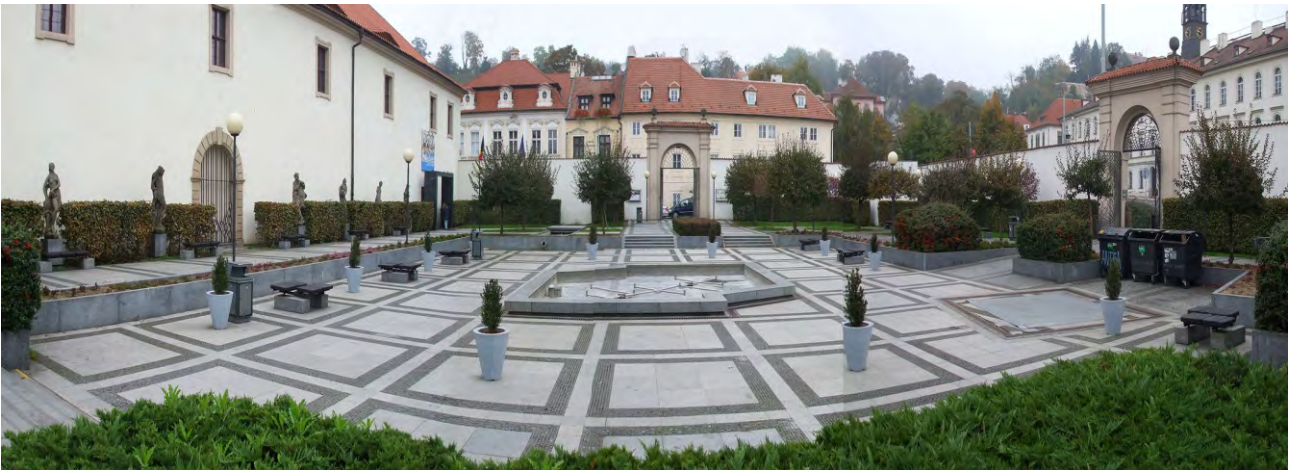
165. orientáló, taktilis burkolatminta a téren, a tereptárgyak a közökben vannak elhelyezve
