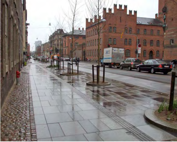
217. normál szélességű, szegélyezett járda vezetősávval
