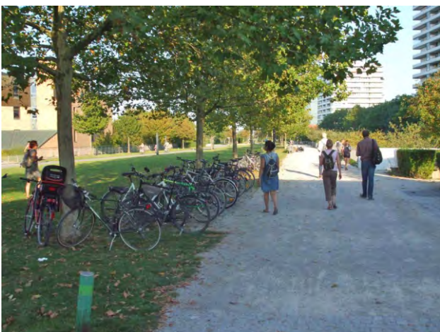
526-527. stabilizált, akadálymentesen használható parkburkolatok, amelyen kerékpárral is lehet közlekedni; a kerékpártárolók a közlekedési nyomvonalon kívül elhelyezve
