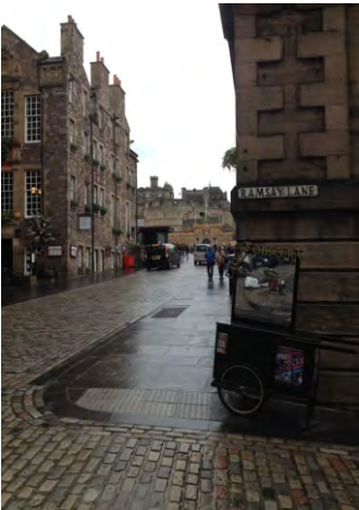
349-351. az átkelőhelyeket taktilis figyelmeztetősáv jelzi, rávezetés nincs, maga a szegélyrampa is taktilis burkolatú, amin nehezebb navigálni
