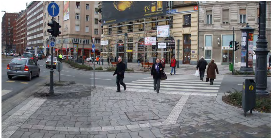
287-288. a rávezetés az átkelő tengelyével párhuzamos, és az átkelő két oldalán egymással szemben található
