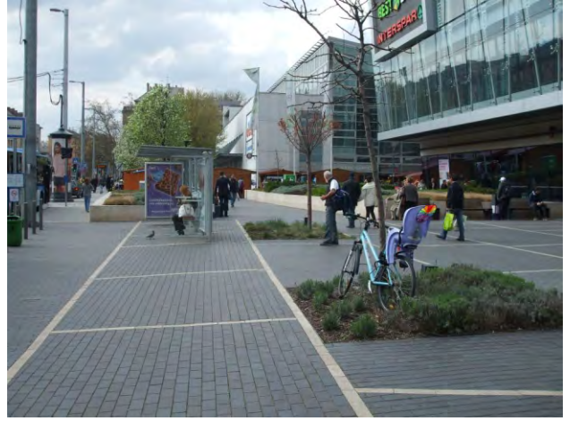
443-444. a megálló megtalálását a burkolatminta és a kiemelt növénykazetta segíti; az első ajtó nem jelzett; kerekesszékekkel használható
