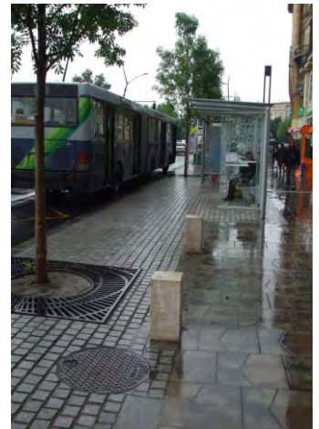
439-440. az első ajtó helye nem jelzett; kerekesszéssel a peron használható
