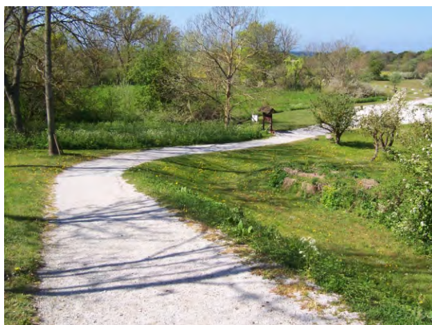
707-708. akadálymentesen, kerékpárral is használható stabilizált burkolat
