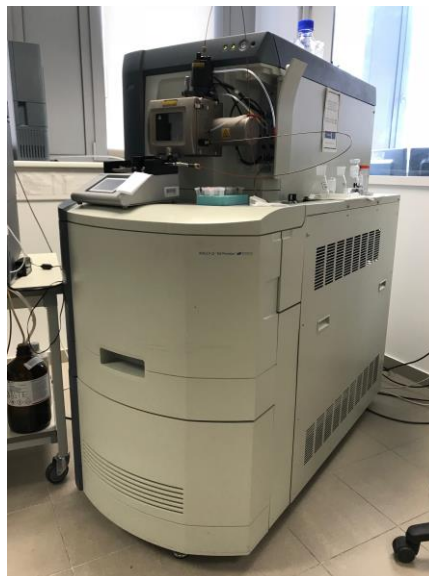
10. ábra – A pontos tömegméréshez alkalmazott ESI-TOF-MS műszer
