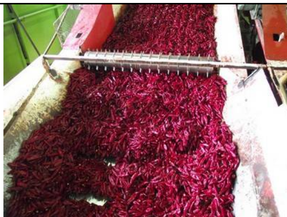
A szárítóüzem mosó berendezésének első szakasza
