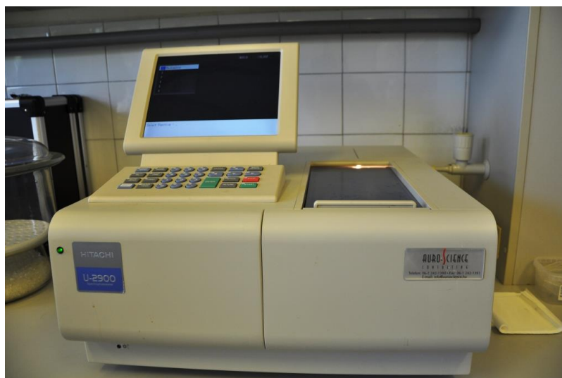
26. ábra: Az antioxidáns kapacitás és az összes polifenol tartalom mérésénél használt spektrofotometer
