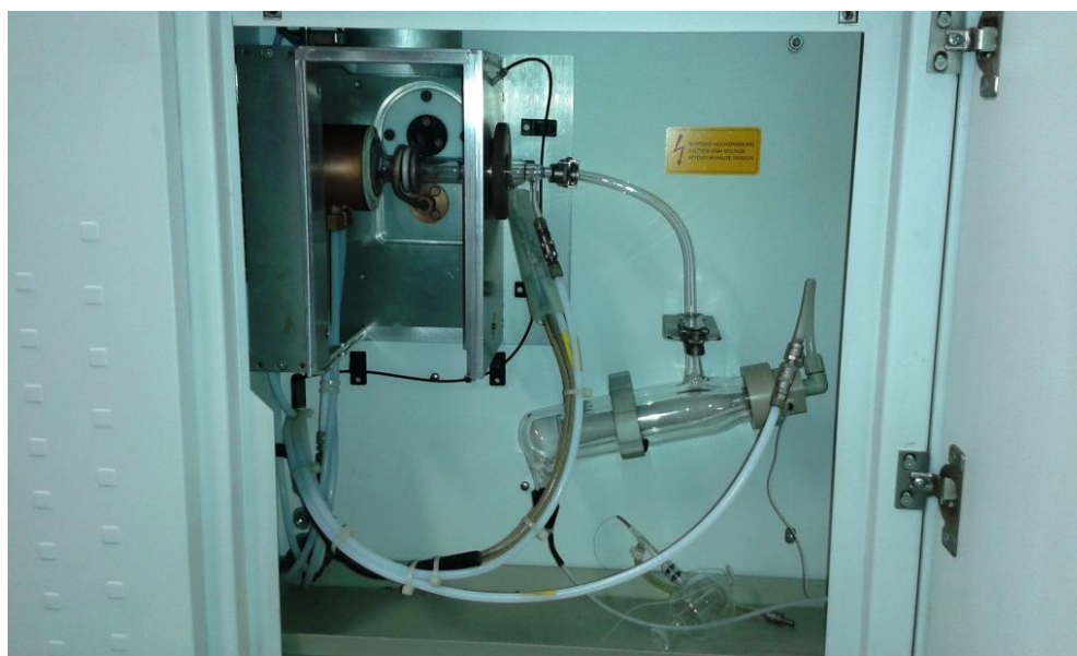
28. ábra: Az ásványi elemtartalom mérésekhez használt ICP-OES készülék belseje
