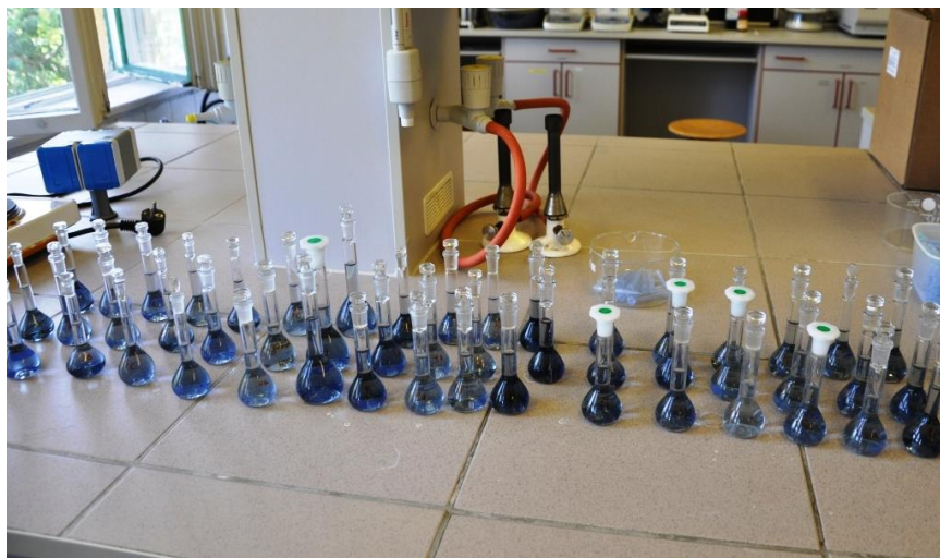
27. ábra: Mintaelőkészítés az összes polifenol tartalom meghatározásához
