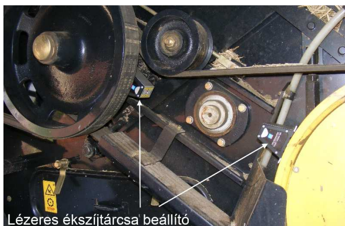
4.2. ábra Gabonabetakarító gép ékszíjhajtás-elrendezése
