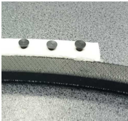
3.18. ábra Ékszíjon kialakított mérési pontok, és pozícionálása
