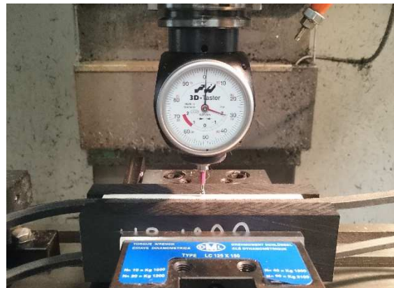
3.18. ábra Ékszíjon kialakított mérési pontok, és pozícionálása
