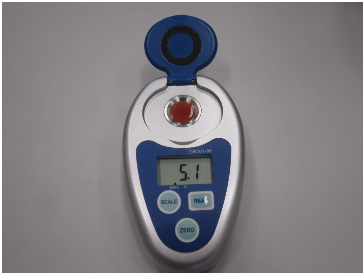
6. ábra A KRÜSS DR201-95 típusú (KRÜSS Optronic, Hamburg, Germany) digitális kézi refraktométer mérés közben.
