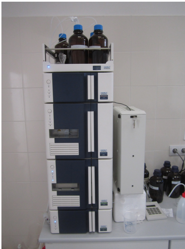
7. ábra Chromaster Hitachi 5430-as modellszámú nagyhatékonyságú folyadékkromatográfia
