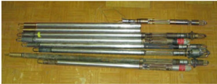
3.3. ábra Szondák KCTG (43mm-es) 3 karu lyukbőség-, hőmérséklet-, és természetes gammamérésre alkalmas szonda (működési tartomány: 125 °C), FTRmOP (43mm-es): áramlás-, hőmérséklet-, folyadékellenállás-, optikai átlátszóság-és nyomás-mérő szonda (működési tartomány: 120 °C)
