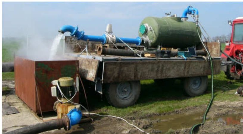
3.8. ábra Hozammérés gázszeperálást követően, előtérben a visszatápláláshoz szükséges szivattyúval
