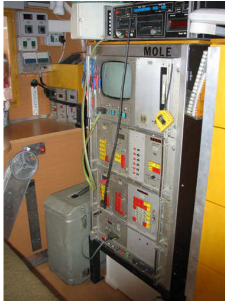
3.2. ábra Az adatrögzítő és kiértékelő egységek (saját felvétel) MOLE – mérési adatgyűjtő (Geo-Log Kft. saját fejlesztése) ALT Logger – mérési adatgyűjtő (ALT)
