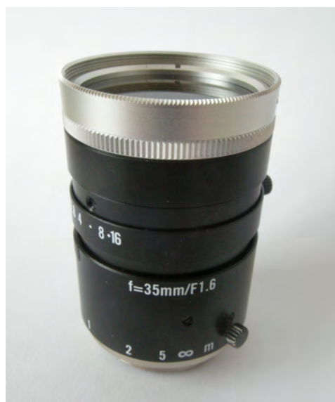
3.11. ábra A kísérletek során alkalmazott, polárszűrővel kiegészített objektív
