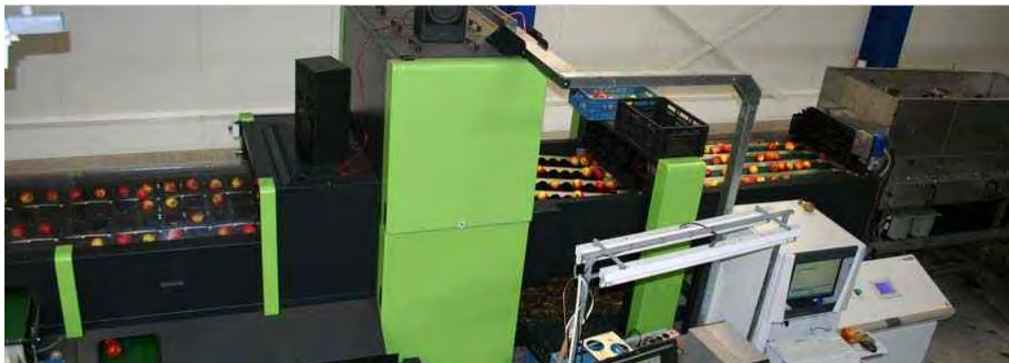
2.8. ábra GREEFA CombiSort elektronikus osztályozórendszer (GREEFA, 2011)
