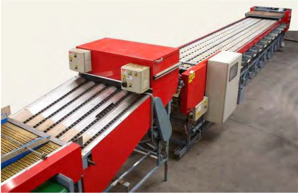
2.7. ábra Aweta elektromechanikus osztályozógép, a szín mérése elektronikusan, a tömeg mérése mérlegkarokkal történik (HORTIMAT 2012c)
