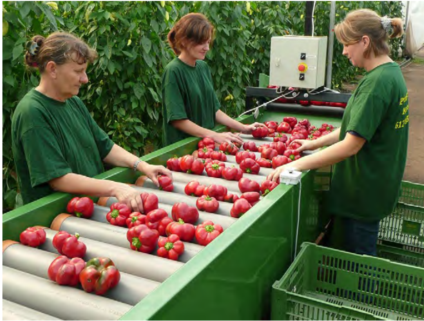
2.2. ábra Görgős (hengerosos) válogató asztal
