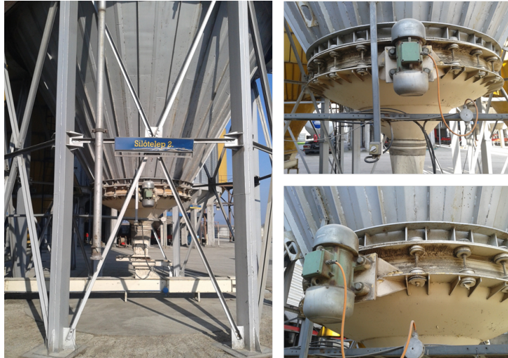
2.21. ábra 30°-os félkúpszögű, 350 m 3 térfogatú, vibrofenekű siló a Gyermelyi Zrt. takarmánykeverő üzemében
