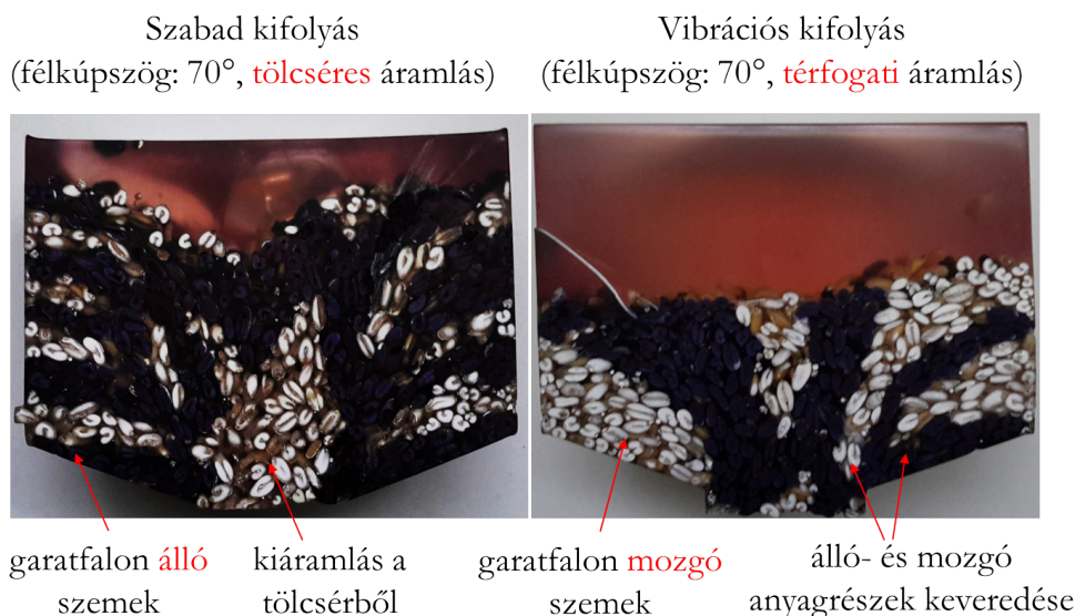
4.39. ábra Az epoxigyantával kifolyás közben "befagyasztott" szabad kifolyású és gerjesztett halmaz
