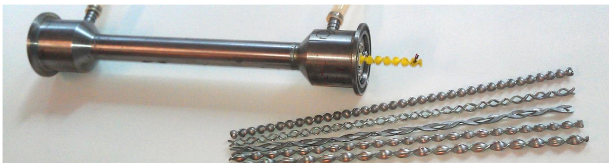
53. ábra Kenics® statikus keverő membrán modulban (balra) és 5 új statikus keverő (jobbra)
