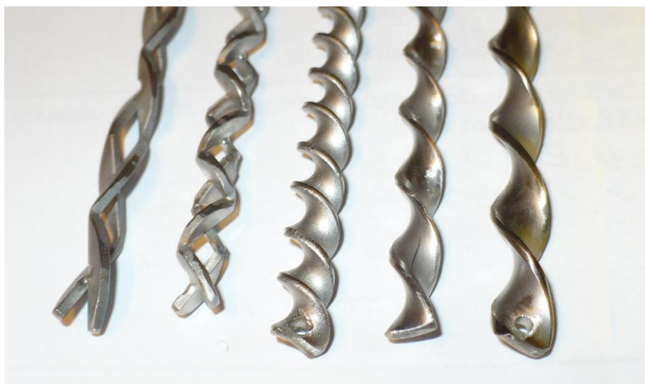
13. ábra Doktori munkám keretében CFD eredmények alapján létrehozott keverők
