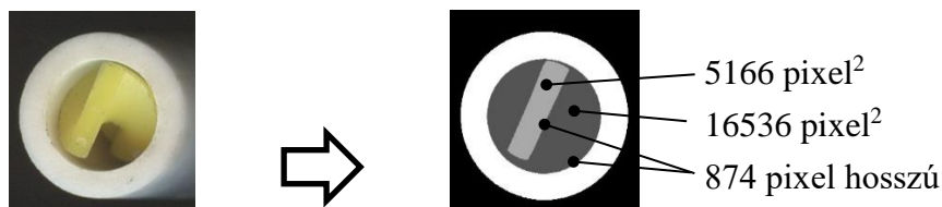
24. ábra Membrán és statikus keverő keresztmetszete. A kép 600dpi felbontásban készült.
