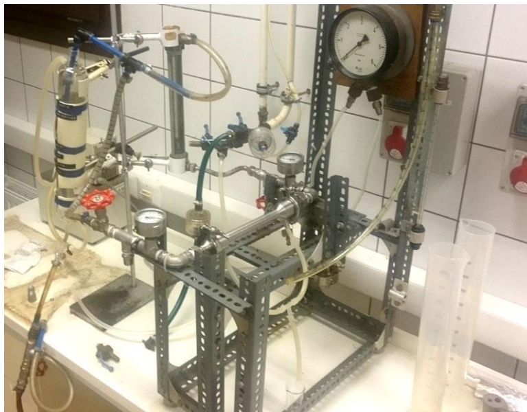
8. ábra Az olaj-víz emulzió ultraszűrésre és tejsavó mikroszűrésre alkalmazott membránszűrő berendezés.
