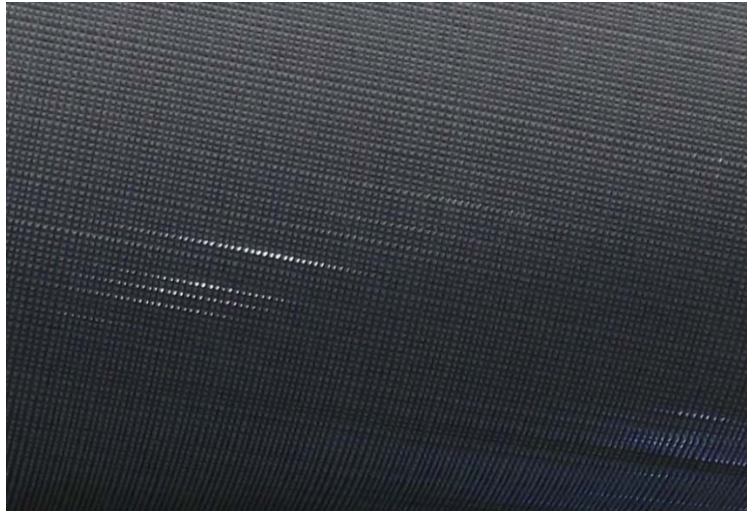
46. ábra A kísérleteknél használt CK721X típusú csiszolópapír
