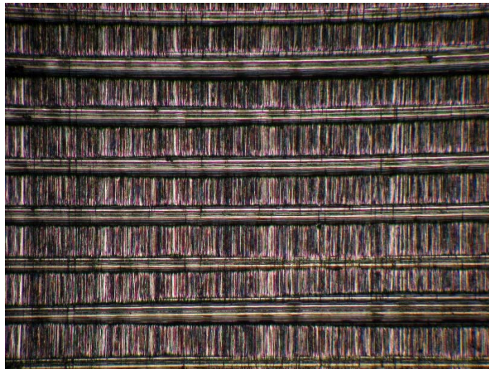
31. ábra Egy kopott alkatrész fémmikroszkópos képe a vízszintes előtolási nyomokkal és a csúcsonában a függőleges karcokkal
