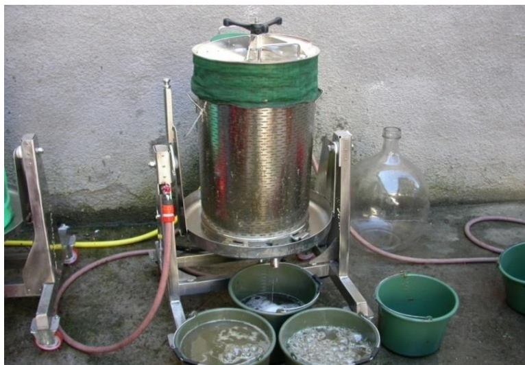
4.2. kép: A mikrovinifikációs tételeknél kis méretű hidraulikus présekkel nyertük ki a mustot
