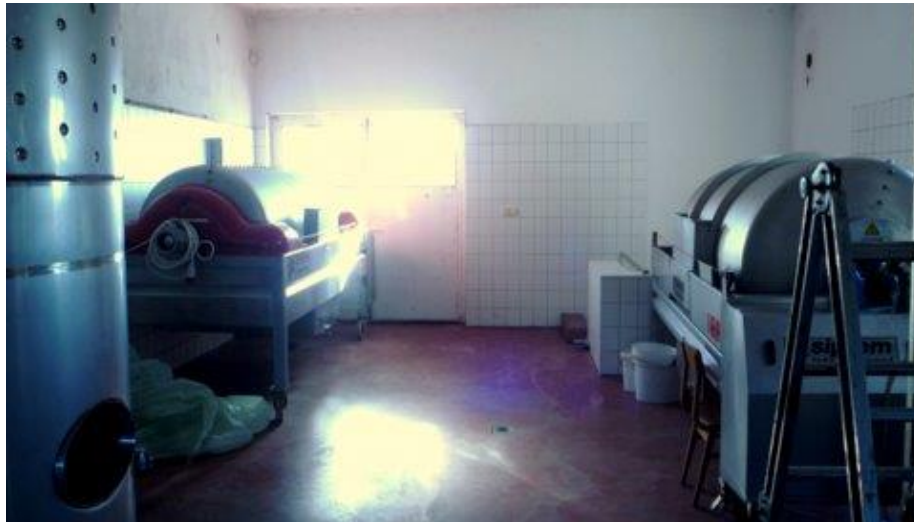
4.1. kép: A Kál-Vin Kft korszerű feldolgozója (Siprem 2000 L-es, pneumatikus membránprések) (Révfülöp, 2009)
