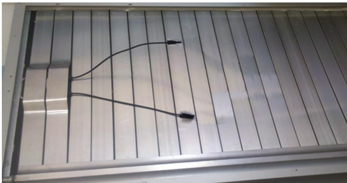
58. ábra. A PV/T modul hátulja a szigetelés nélkül
