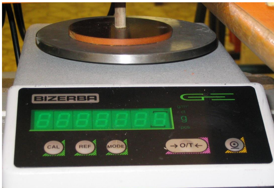
3.6. ábra Bizerba GE 2000-65 digitális labormérleg
