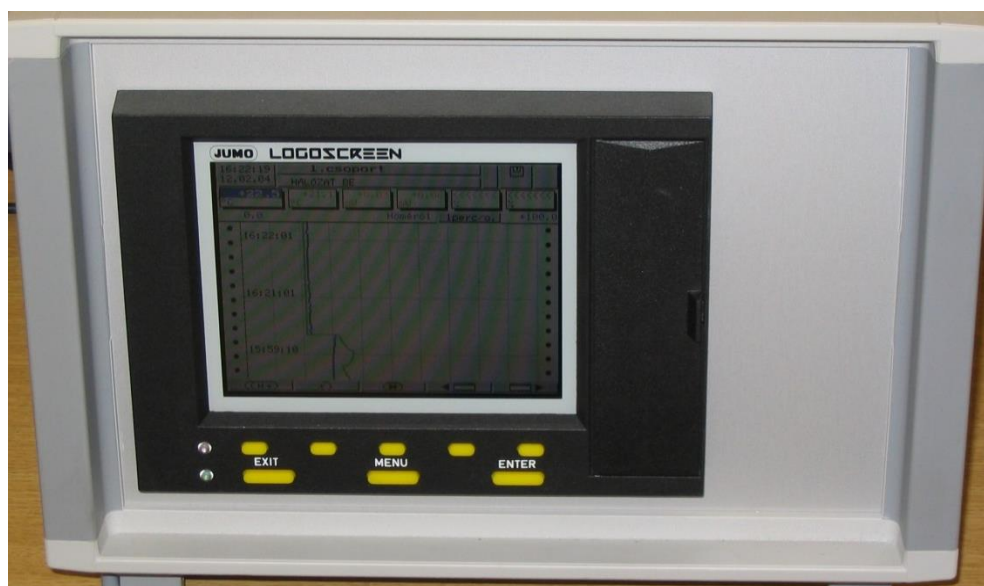
3.5. ábra Logoscreen adatgyűjtő egység
