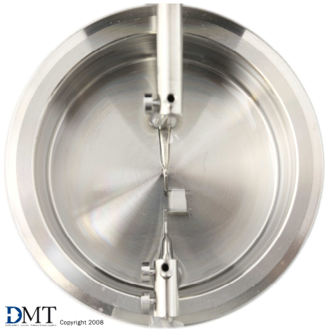
49. ábra. A miográfia során alkalmazott miográfiás kád és az érgyűrűt tartó két 200 \mu\text{m} átmérőjű, egymással párhuzamos rozsdamentes acél tű látható.
