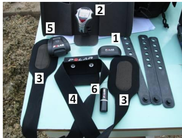
1: jeladó, 2: HR-vevőkészülék, 3: elektróda, 4: elektródahám, 5: GPS, 6: adatátvivő
