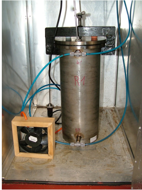
5. kép Aerob vizsgálatokhoz használt reaktorok
