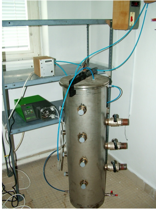
3. kép Félszáraz, szakaszos üzemű anaerob reaktor anaerob-aerob kísérlet esetén
