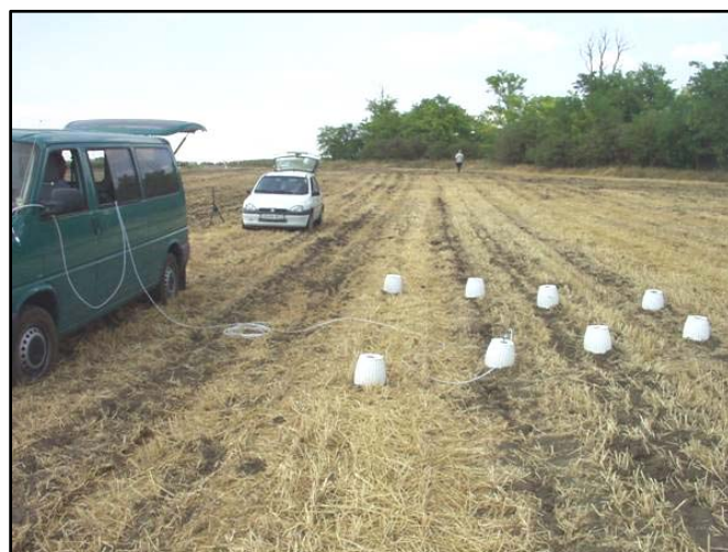
3.18. ábra. A mérőkocsi és a mintavevő edények a különböző mérőrendszerek összehasonlító vizsgálatánál
