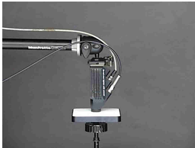
31. ábra: Kontakt referenciamérés Plant Probe szenzorfejjel 130 [mm] *130 [mm]-es referenciapanelen.
