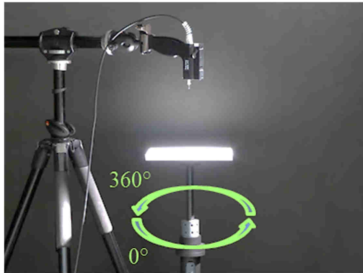
43. ábra: Mintaforgató rendszerrel javított „ProLamp eljárás”-al egy teljes körbeforgatás alatt végzett fehér referenciamérés.
