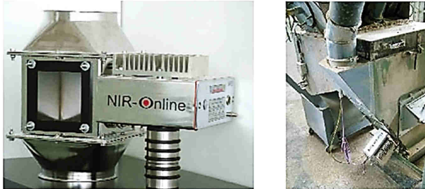
14. ábra: A NIR-Online egység (balra) beszerelve a takarmánykeverő garat kilépési pontjába (jobbra) (Dunn, 2008).
