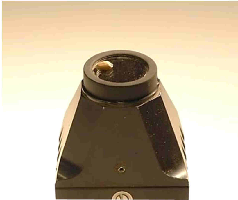
76. ábra: Plant Probe szenzorfej pereme és az üveglap által meghatározott tér (mélység 2 [mm], átmérő 18 [mm]).
