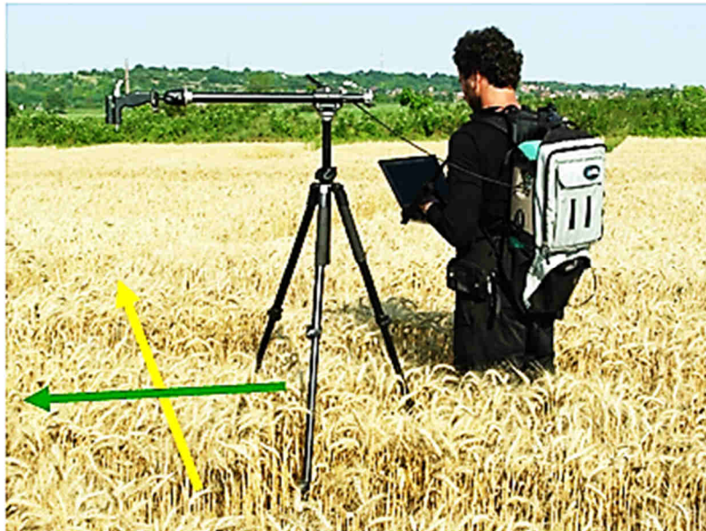
49. ábra: Mérési elrendezés a terepi mérés során (sárga nyíl: a Nap principális síkja, zöld nyíl: a principális síkra merőleges mérési sík).
