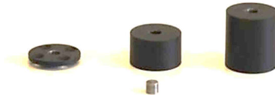
40. ábra: Kis mennyiségű minták kontakt mérésekhez készített tárgyasztal és mintatartók (átmérő: 50 [mm]).
