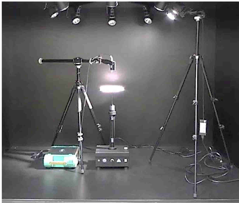
42. ábra: Mintaforgató rendszerrel javított „ProLamp eljárás”: Egyirányú megvilágítás ProLamp fényforrással és mintaforgató rendszerrel.
