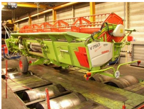
3.5. ábra: A CLAAS vállalat görgős tesztpadja Harsewinkelben
