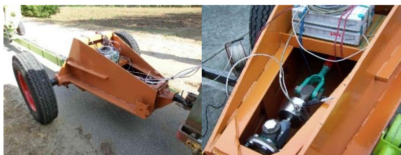
3.10. ábra: A Mezőgazdasági Gépesítési Intézet vonóerő mérésére alkalmas vontató kocsija
