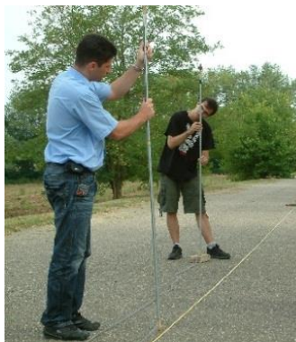
3.12. ábra: Profilométer alkalmazása aszfalt burkolatú úton
