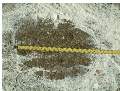
3.16. ábra: A gumiabroncs felfekvési felület átlójának meghatározása
