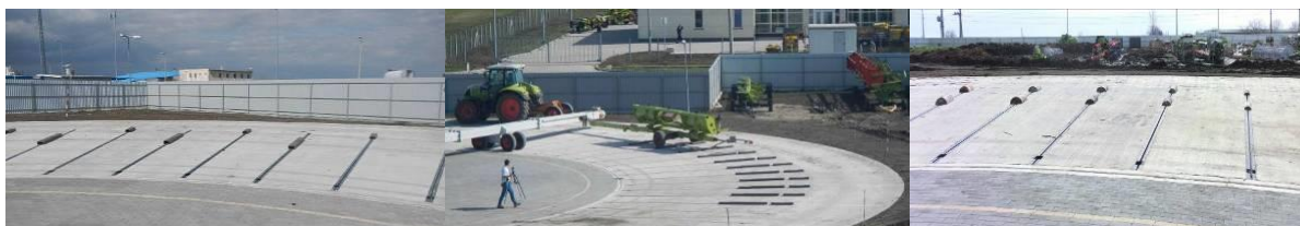
3.54. ábra: Ütésszerű igénybevételeket előidéző akadálytípusok
