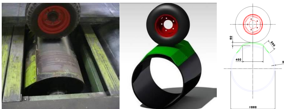
3.42. ábra: Akadálykialakítás a görgős tesztpadon
