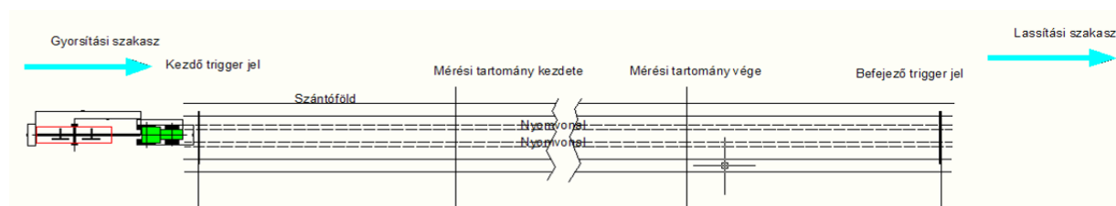
3.39. ábra: Szabadföldi mérés menetének bemutatása
