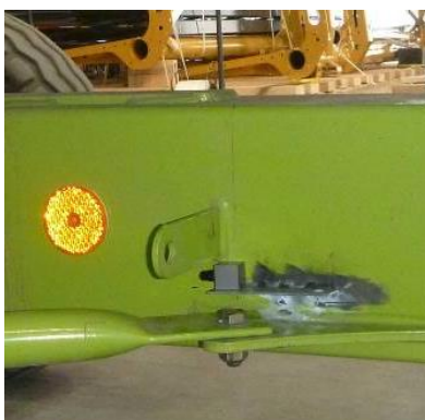
3.31. ábra: Gyorsulásérzékelő felhelyezése a súlypontba a lengésvizsgálat során
