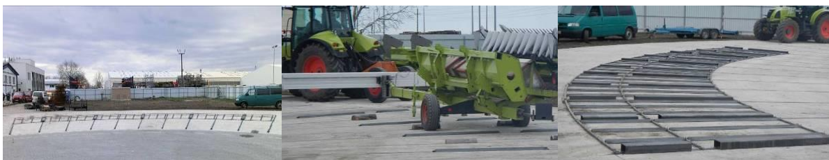
3.55. ábra: Ütések és rezgéseket is előidéző vegyes akadálytípusok
