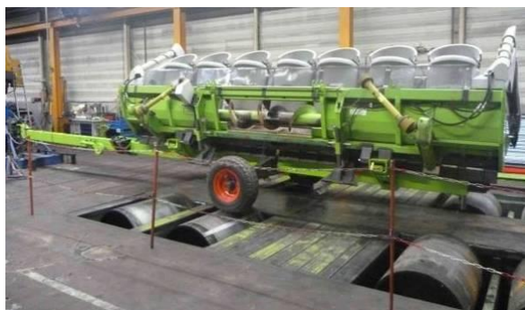
3.41. ábra: Görgős tesztpadon történő mérés
