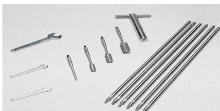
3.13. ábra: GEONOR H60 típusú kézi torziós talajnyíró készülék
