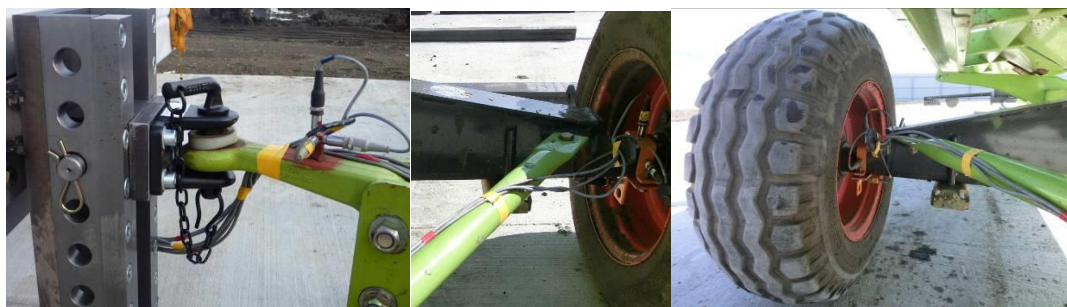
3.9. ábra: Gyorsulásérzékelők rögzítési pontjai
