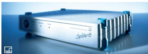
3.11. ábra: Hottinger Spider 8 adatgyűjtő egység (www.hbm.com)
