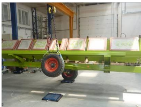
3.30. ábra: Tömegközéppont meghatározása a vontatmány megemelésének módszerével
