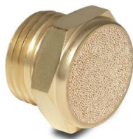
5. ábra Pneumatikai hangtompító. A hangtompító az átáramló gázt gömbszerűen szórja ezzel csökkentve az áramlási zajt a kamrán belül.
