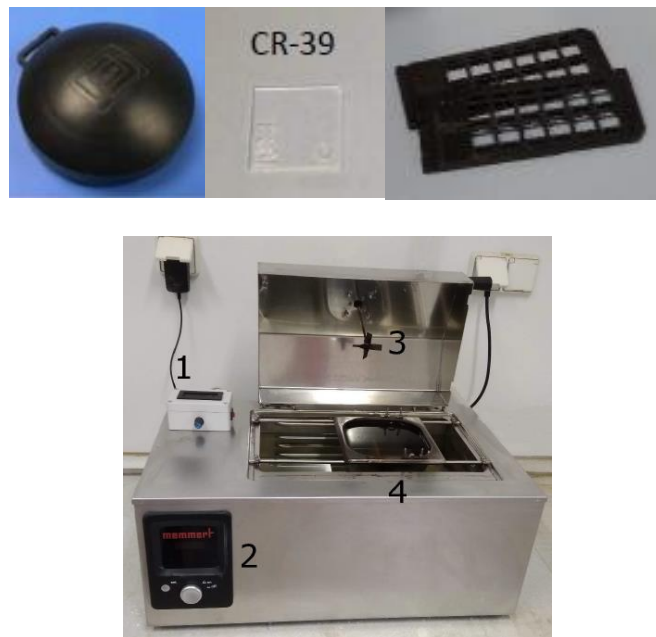
15. ábra: NRPB tok, CR-39 nyomdetektor, rácsos rögzítő, marató (1: fordulatszám szabályzó, 2: hőmérséklet-szabályzó, 3: keverőszár, 4: maratókád)
