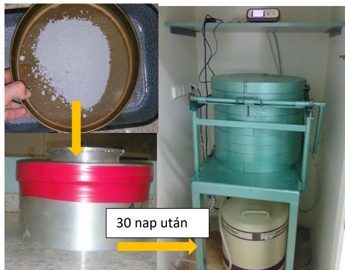
17. ábra: Talajminta Ra-226 mérésre való előkészítése, mérése
