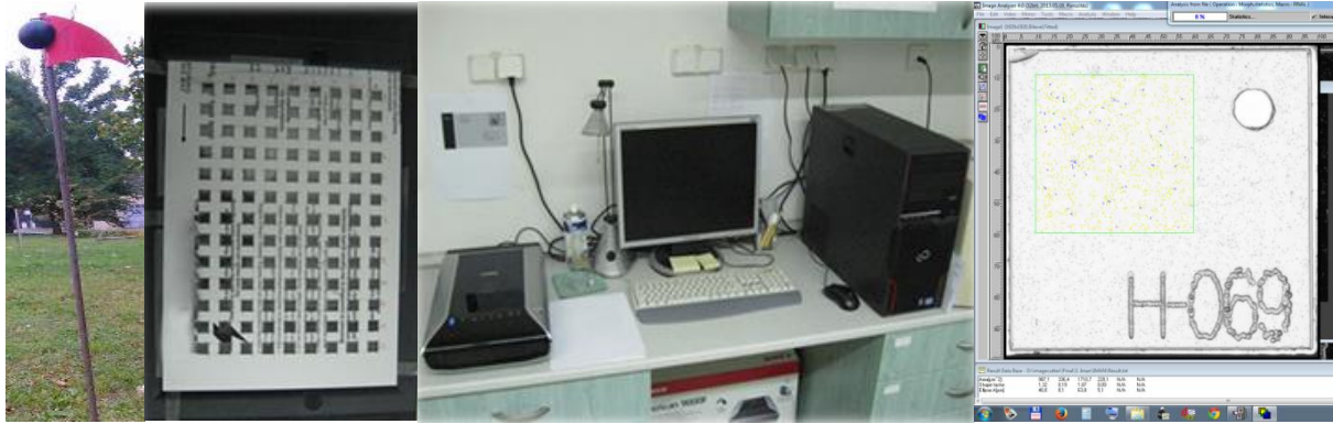
16. ábra: Rn-222 mérés és kiértékelés folyamata
